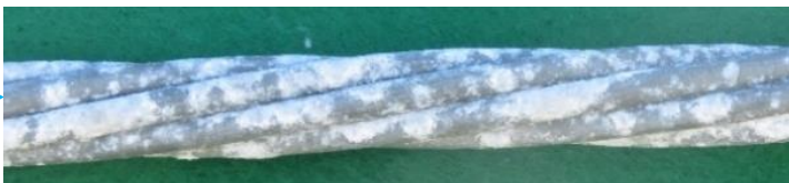
三元合金めっき鋼より線 (2505日後)
